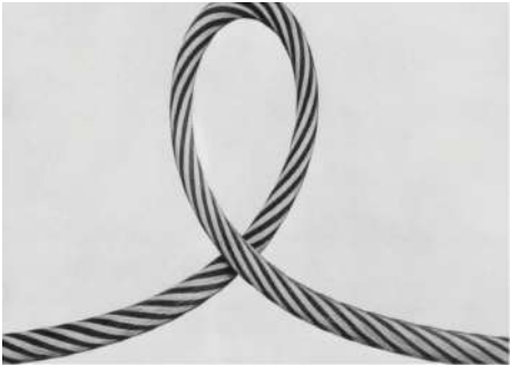
DETERIORO POR RISO
