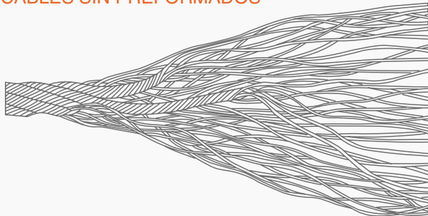
CABLES SIN PREFORMADOS
