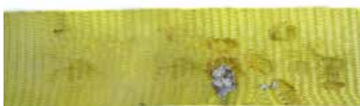
CHISPAS DE SOLDADURA
