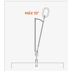
Para mordazas de elevación verticales con suspensión fija no está permitido izar con una inclinación mayor a 10° (izquierda). No ha sido diseñada para tracción diagonal.
