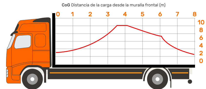
Diagrama de distribución de la carga en un camión de dos ejes
